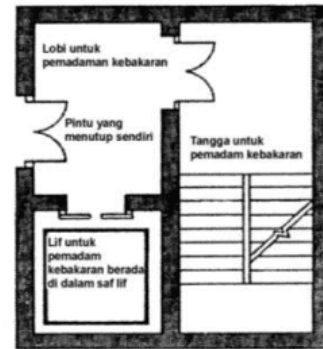
Gambar 2. Persyaratan shaft kebakaran (Permen PU No.26/PRT/M tahun 2008.)
