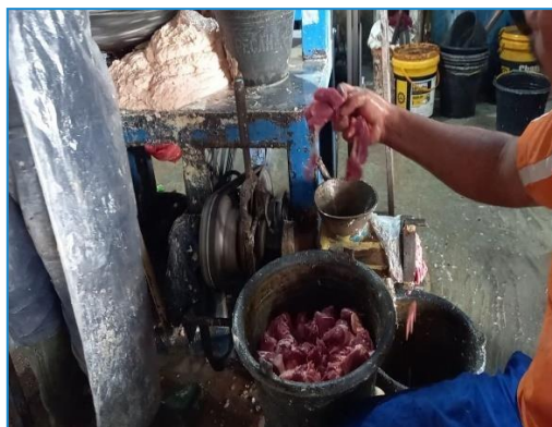
Gambar 2 Menunjukkan proses pengolahan mesin penggilingan bakso setelah memasukkan potongan daging (Sumber: Dokumentasi Pribadi)
