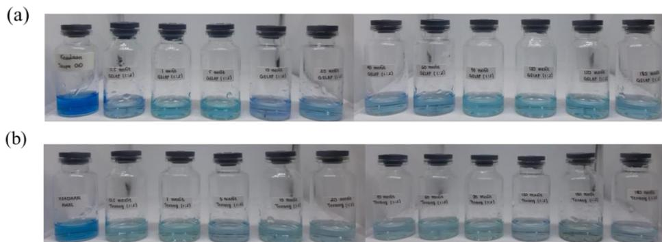
**Gambar 1.** Perbandingan permeat hasil adsorpsi larutan MB oleh GO pada berbagai waktu pencuplikan sampel pada proses adsorpsi tanpa penyinaran (a) dan proses adsorpsi dengan perlakuan penyinaran (b)
