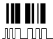
Gambar 3 Tampilan Sinyal Hasil Pembacaan Photo Dioda pada Barcode
