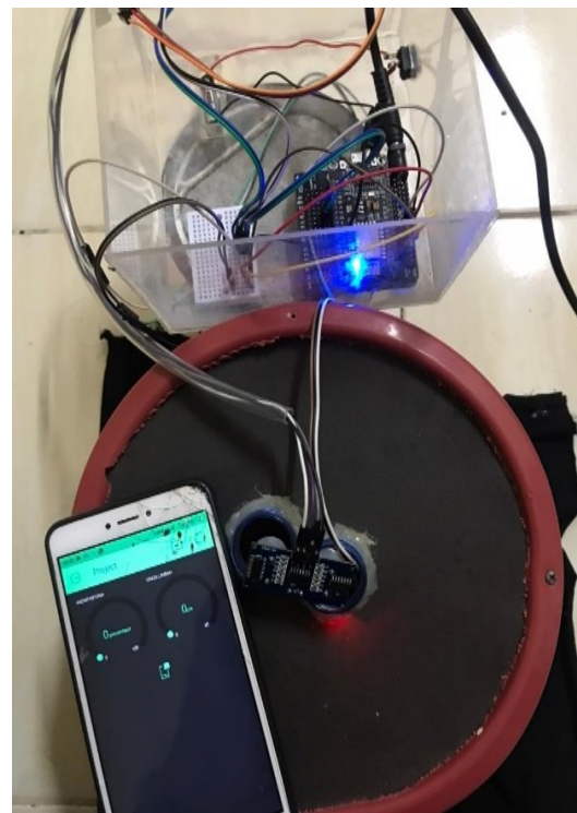
Gambar 4. Hasil Rangkaian Alat Pendeteksi pada Septic Tank
