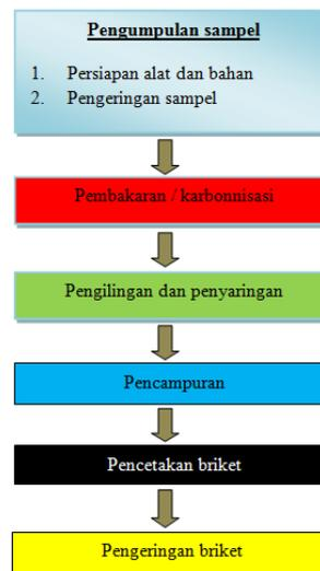
Gambar 2. Diagram alir proses pembuatan briket (Sumber: analisa 2012)
