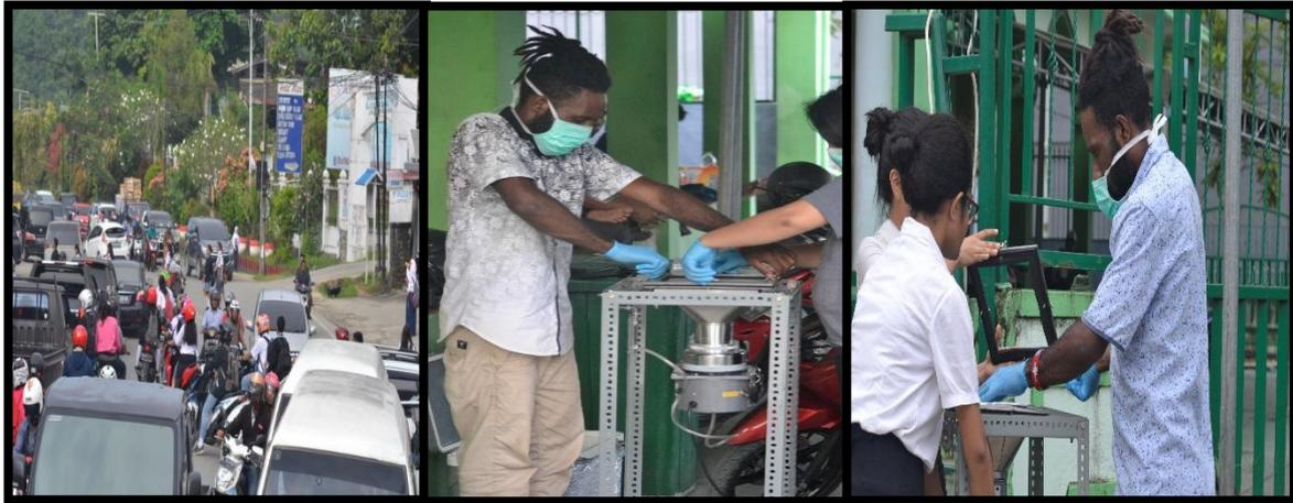
**Gambar 1.** Pengukuran Sampel Udara TSP, (Depan Masjid Al-Hidayah Entrop)
