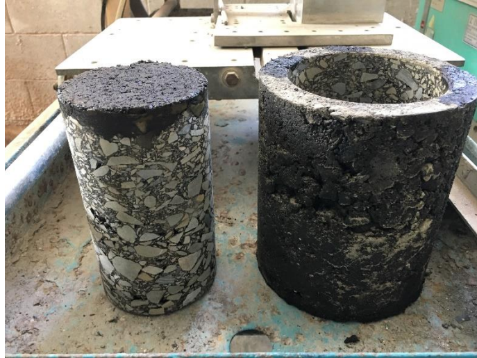
Gambar 2. Sampel setelah coring dan pemotongan
