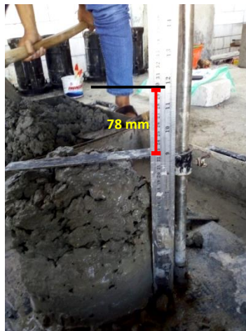
Gambar 4.8 Pengukuran Slump
