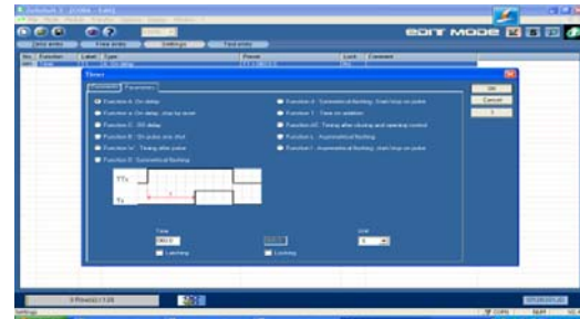
Gambar 19. Mengatur timer sistem kontrol pada PLC Zeliosoft2
