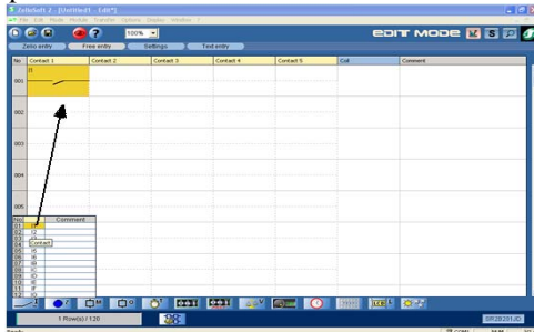
Gambar 18 Contoh cara pemasukan input pada ladder line
