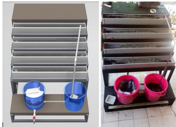
Gambar 2. Alat Adsorpsi Rancangan dan Aplikasinya
