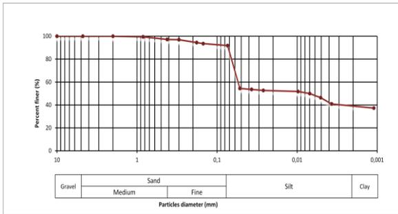
**Gambar 5** Grafik Hasil Analisis Saringan dan Hidrometer
