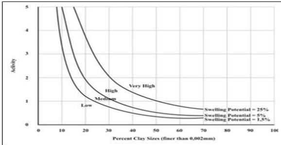
**Gambar 3** Grafik klasifikasi potensi mengembang (Seed et al., 1962)
