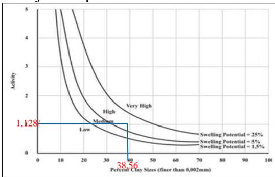
**Gambar 7** Grafik Klasifikasi Tanah Berdasarkan Potensi Mengembang
