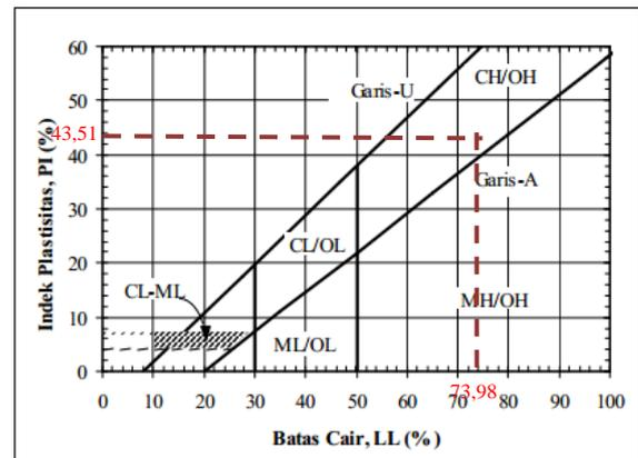
**Gambar 6** Grafik Klasifikasi Tanah Berdasarkan Sistem *Unified*
