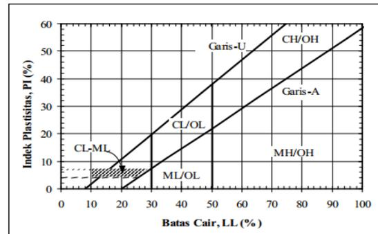
**Gambar 1** Grafik Plastisitas untuk klasifikasi tanah USCS
