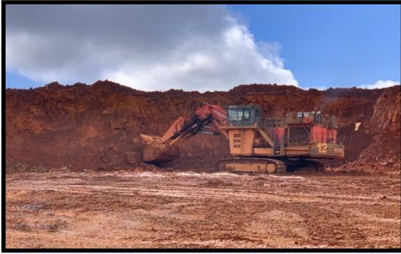
Gambar 3. Proses kegiatan pengupasan tanah penutup (stripping)
