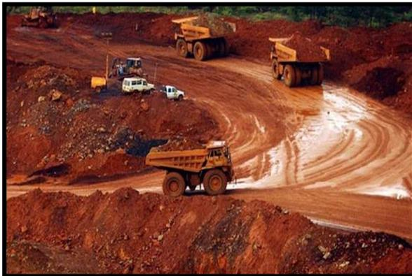
Gambar 12. Jarak beriringan antar dump truck terlalu dekat.
