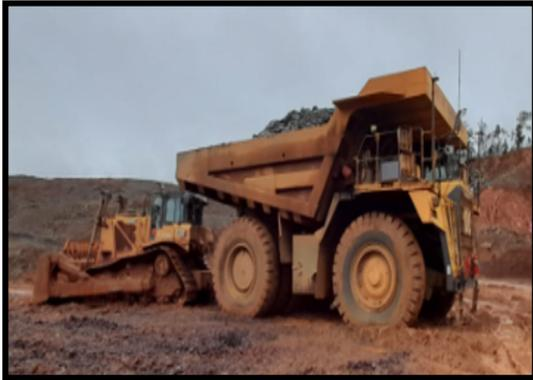
Gambar 16. Jarak antar dozer dan dump truck terlalu dekat.
