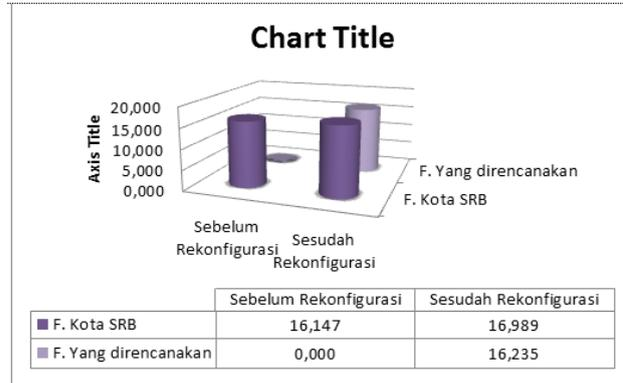
Gambar 4 Grafik perbandingan rugi daya pada sistem 20 kV sebelum dan sesudah rekonfigurasi
