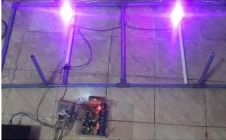
Gambar 6. Pengujian rangkaian penggerak relay
