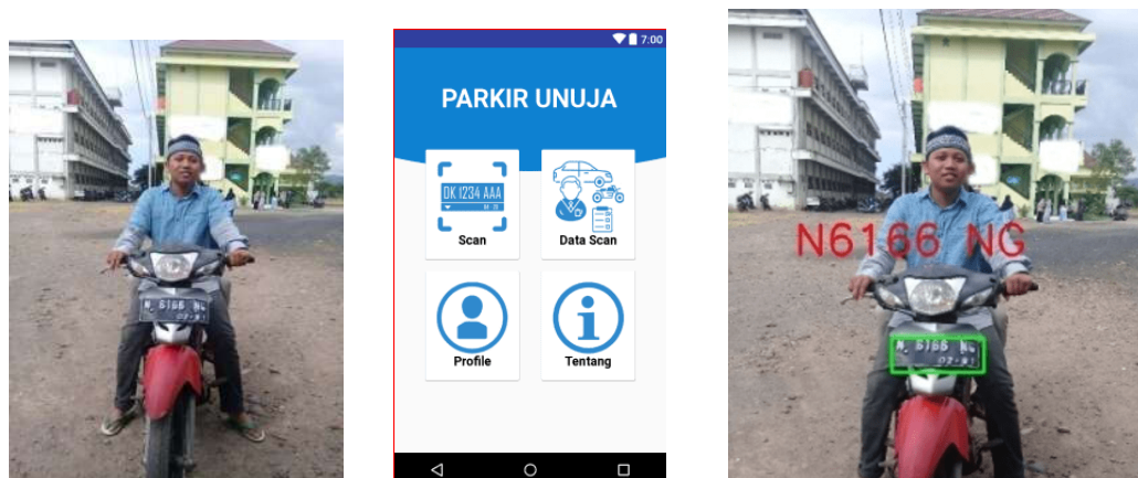
Gambar 15. Cara kerja Scan OCR di Android
