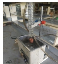
Gambar 1. Set refluks saponifikasi dengan gelombang ultrasonik.
