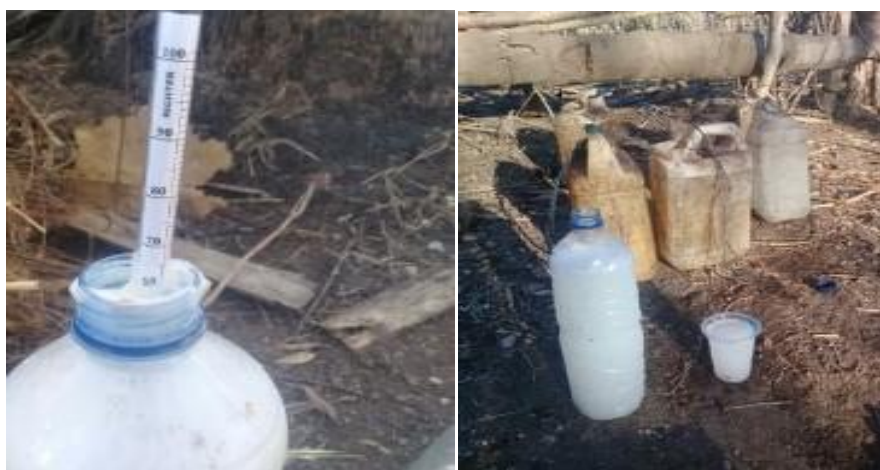
Gambar 2. a) Pengukuran kadar alkohol nira, b) Pengukuran pH nira dan padatan terlarut nira
