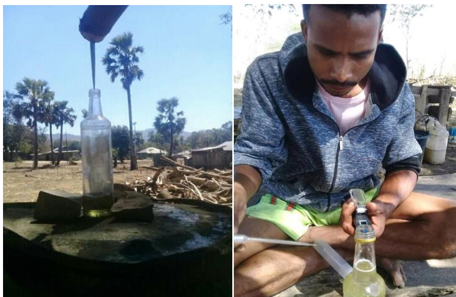
Gambar 3. Proses Penyulingan dan pengukuran kadar alkohol Sopi
