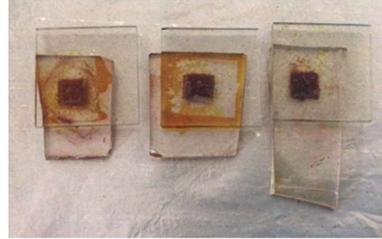
**Gambar 2.** Purwarupa sel surya tipe DSSC setelah selesai dirakit dengan fotoanoda  $\text{TiO}_2$  dan ZnO.
