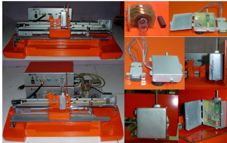
Gambar 7. (a).Prototipe pengukur Sampel (b) Prototipe LVDT dan Stylus
