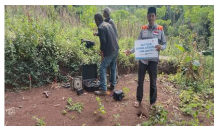
Gambar 4. Pengukuran Geolistrik Lokasi Pengeboran
