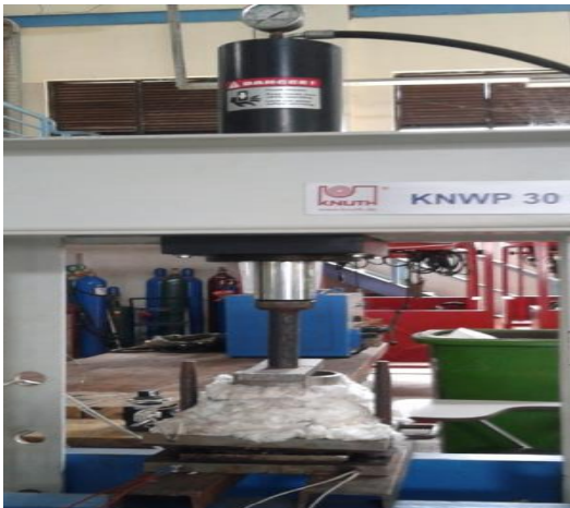
Gambar 3. Proses hot press komposit
