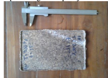
Gambar 7. Pelat komposit kayu plastik hasil hot press
