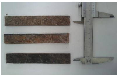
Gambar 5. Sampel uji lentur
