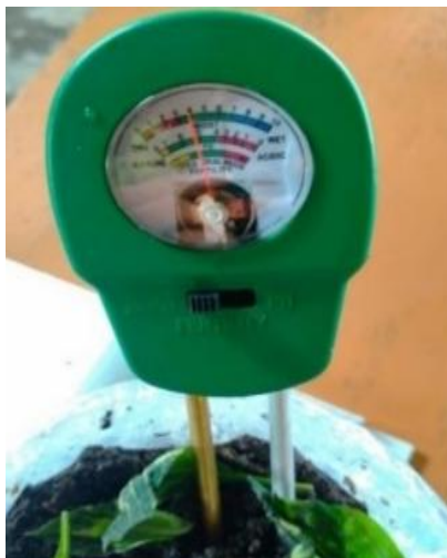
Gbr. 4 Pengujian Memakai Alat Ukur Kelembaban Tanah ( Soil meter)
