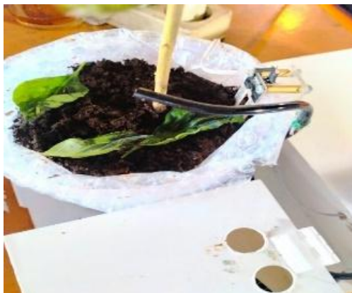
Gbr. 5 Probe Sensor Pengujian Kelembaban Tanah Pada Tanah Normal
