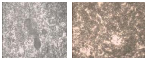
Gambar11. :Foto micro potongan piringan katup hisap original dan lokal bagian no 3 pembesaran 1000x
