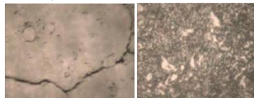
Gambar14: Foto micro potongan batang katup buang original dan lokal bagian no 2 pembesaran 1000x
