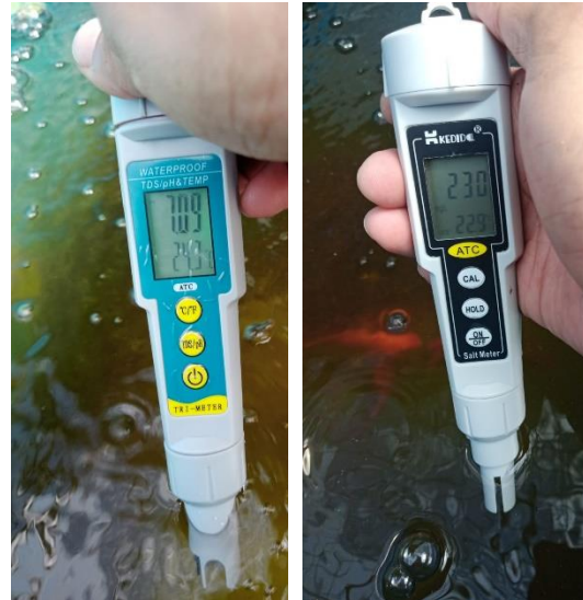
Gambar 5. Proses pengukuran keasamaan dan kepadatan partikel dalam air
