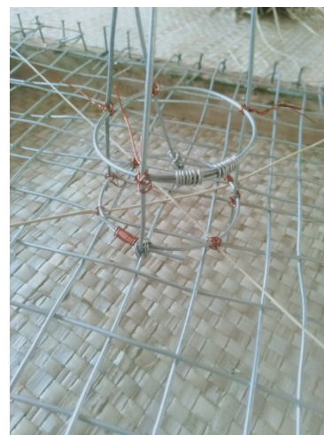
Gambar 11. Pembuatan konstruksi dasar tiga dimensi diatas jaringan anyaman kawat
