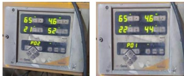
Gambar 1. Program P01 & P02 pada *spray gun control unit*
