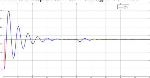
Gambar 15 Grafik suhu reaktor dengan pengendali pid, setpoint tetap dan gangguan diturunkan
