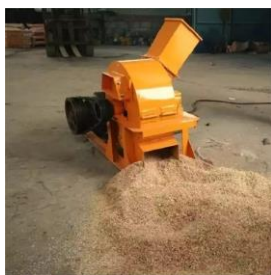
Gambar 1.1 Hasil produk mesin serut bambu yang sudah ada.
