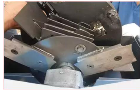
Gambar 1.2 Desain mata pisau pada mesin yang sudah ada.
