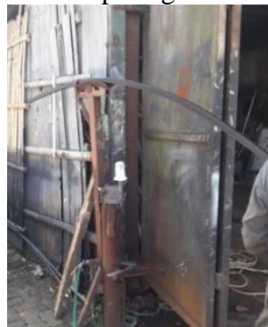
Gambar 2. Proses bending dengan metode manual
