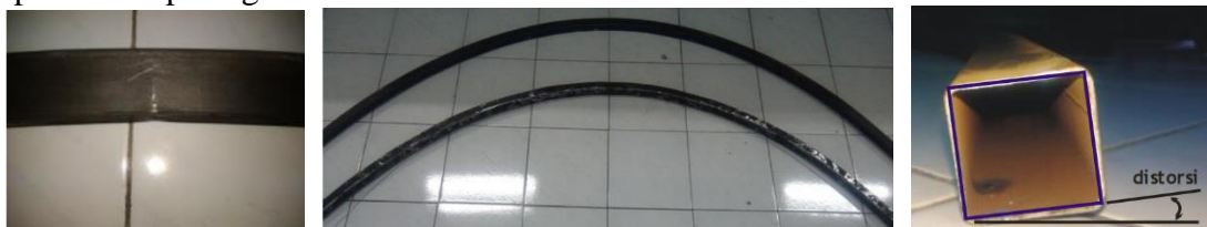
Gambar 3. Cacat produk pada proses bending manual
