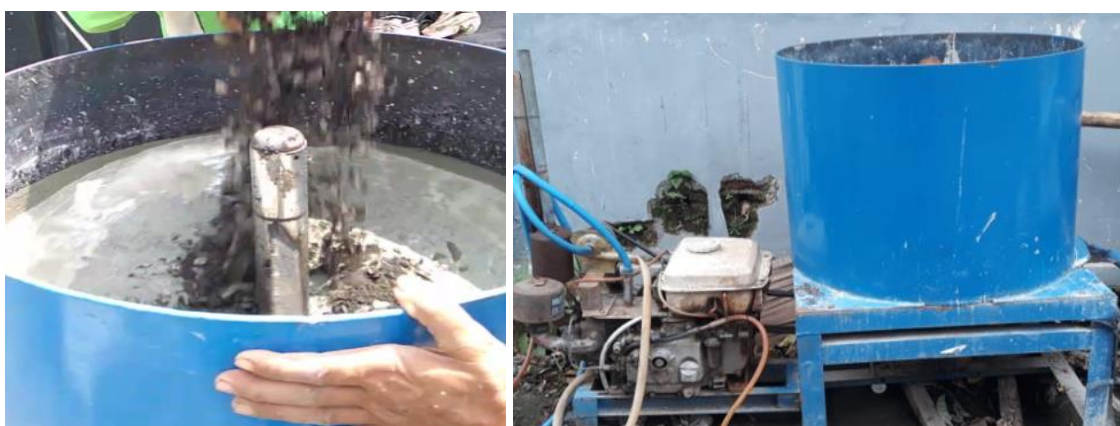
Gambar 4. Proses Peradukan Semen, Pasir, Koral Dan Air
