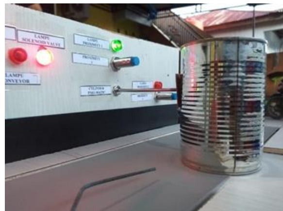
Gambar 12. Sensor Proximity 1 Mendeteksi Benda Uji Ukuran Tinggi
