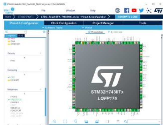
Gambar 4 Konfigurasi mikrokontroler di STM32CubeMX
