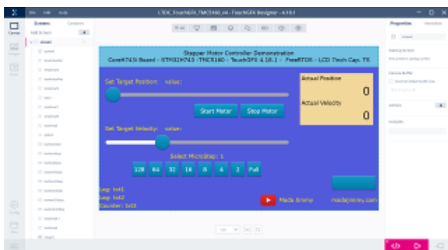
Gambar 5 Penyusunan letak widget pada TouchGFX Designer
