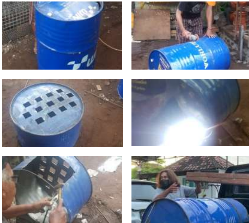
Gambar 4. Proses Perakitan Trash Burner oleh mahasiswa KKN UNS
