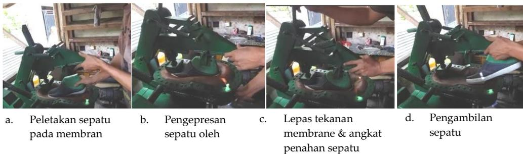
**Gambar 6. Pengujian mesin pres sepatu**
