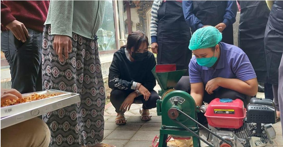
Gambar 7. Proses penepungan dengan mesin
