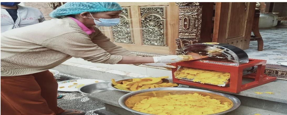
Gambar 4. Proses Penyawutan atau Pemotongan dengan Mesin
