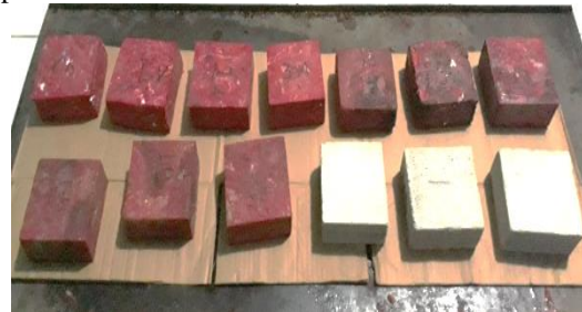
Gambar 1. Hasil Pengujian Kuat Tahan Panas pada Suhu 120°C
