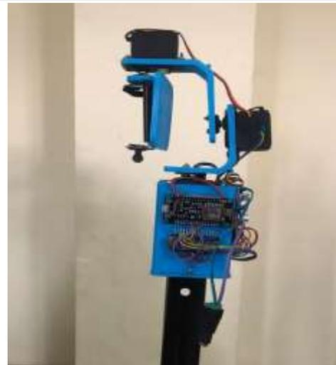
**Gambar 10.** Tampak Samping Sistem Pengendalian Kamera Jarak Jauh Terintegrasi *Internet Of Things*
