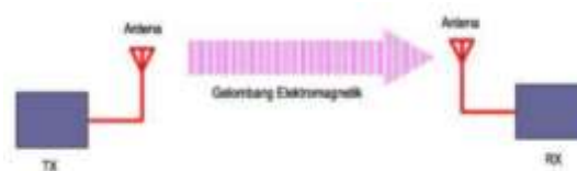
Gambar 1. Antena sebagai Transmitter dan Receiver. [12]
