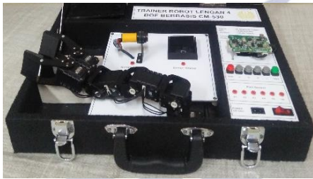
Gambar 2. Trainer Robot lengan dengan 6 DoF berbasis CM-530
