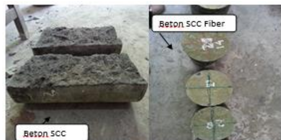
Gambar 8. Silinder beton yang telah diuji Tarik Belah
