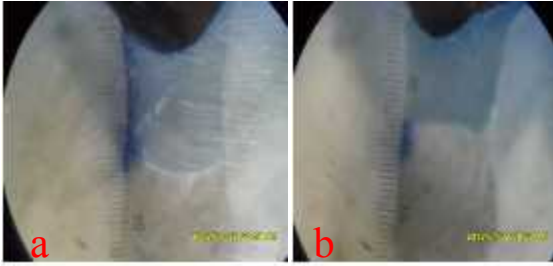
Gambar 4 Spesimen yang mengalami kebocoran mikro pada basis GIC Conventional . Spesimen A2 (a) dan Spesimen A6 (b)
