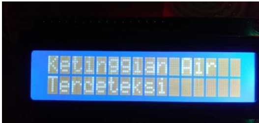
Gambar 23. LCD saat Ketinggian Air Terdeteksi
