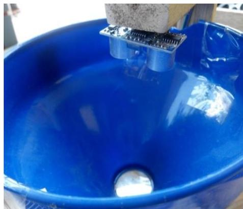
**Gambar 12.** Letak Sensor Ultrasonik
