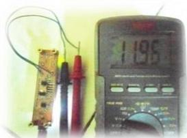
**Gambar 23.** Dokumentasi Pengujian Rangkaian *Relay*
