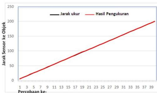
**Gambar 27.** Grafik Hasil Pengujian Sensor Ultrasonik HC-SR04
