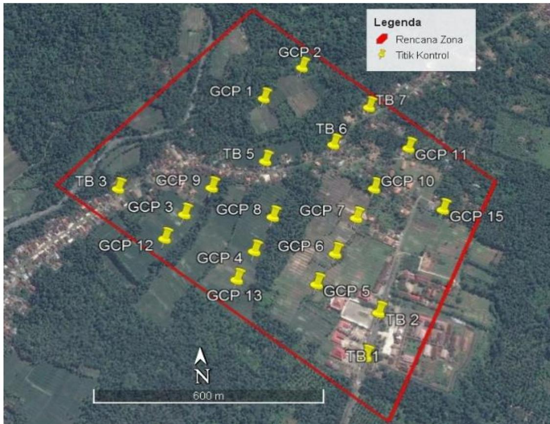
Gambar 3. Titik Kontrol Tanah
