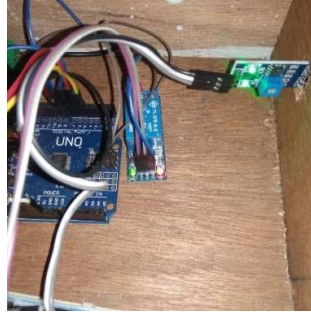
Gambar 29. Relay Dalam Kondisi Menyala Saat Sensor Infrared Menyala
