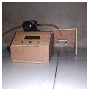
Gambar 26. Tampilan Depan Alat Pengisi Saos Berbasis Arduino
