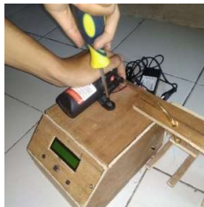
Gambar 17. Pemasangan Pompa Diafragma ke Rancangan Triplek
