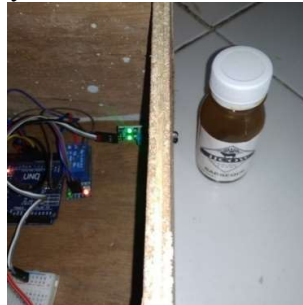
Gambar 28. Sensor Infrared Menyala Ketika Mendeteksi Benda di Depannya
