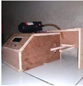
Gambar 27. Tampilan Samping Alat Pengisi Saos Berbasis Arduino
