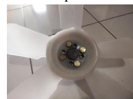
Gambar 8. Sudu dan Adaptor Sudu Terpasang
