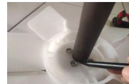
Gambar 6. Penyesuaian Ukuran Lubang Sudu Dengan Adaptor Sudu
