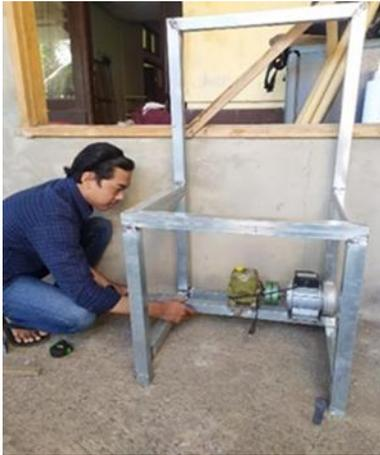
Gambar 15. Penyambungan Gearbox & Motor AC
