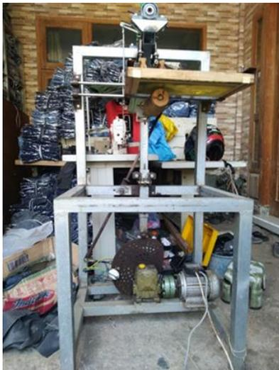
Gambar 26. Hasil Pembuatan Mesin Sablon Semi Otomatis
