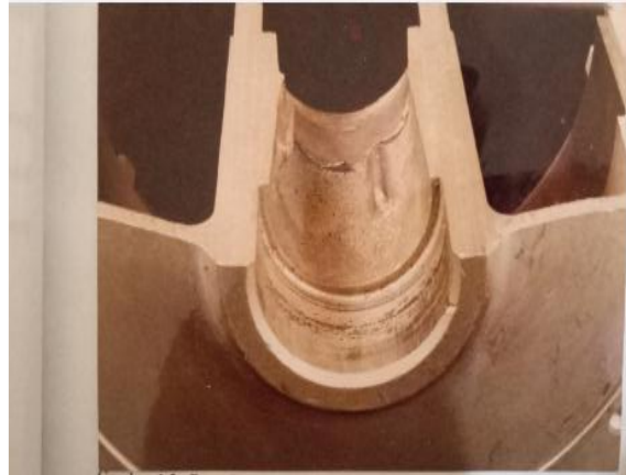
Gambar 2. Cacat soldering pada permukaan casting
